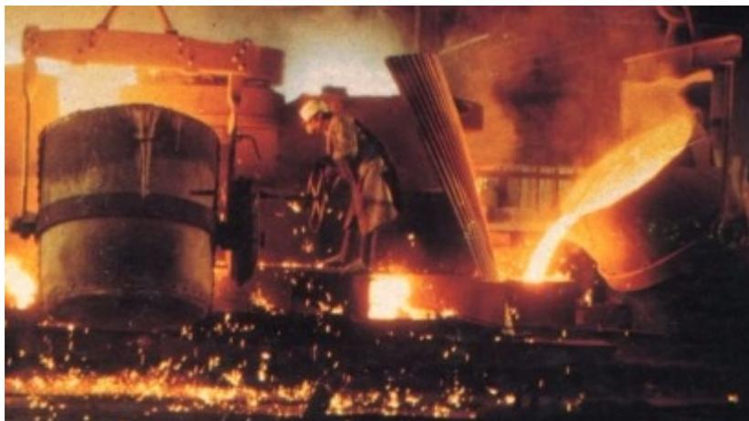
En quelques minutes, trois poches de coulée pouvaient déverser plus de 40 tonnes de métal liquide porté à 1200 °C dans le même moule.
