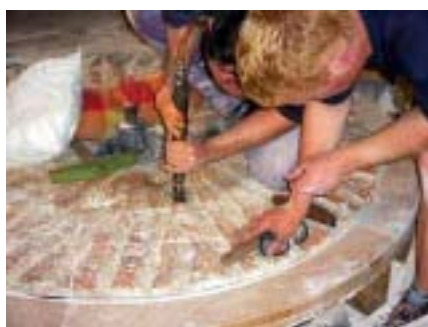
Le rhabillage des meules de notre moulin par Peter Thomaes et son ouvrier, à gauche avec une boucharde pneumatique et à droite avec un piochon.
