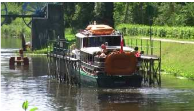
Le bateau se positionne au dessus du chariot et s'y amarre.
