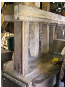
Le mini tordoir à huile permet une démonstration du pressage de la graine de lin en huile.
