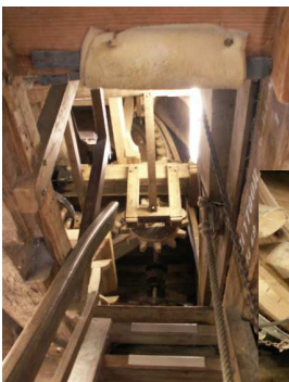
La montée à l'étage de la meule, avec le rouet, la lanterne, la trémie.
