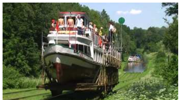
Deux chariots circulent sur deux voies ferrées sur la dénivellation entre deux portions de canal en eau. Un câble tire l'un en montée et retient l'autre en descente.
