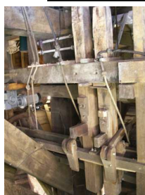
Le mini tordoir à huile permet une démonstration du pressage de la graine de lin en huile.
