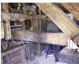
Le mini tordoir à huile permet une démonstration du pressage de la graine de lin en huile.
