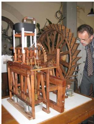
La machine élévatrice se compose d'une roue à aubes mue par l'énergie hydraulique provenant d'une dérivation du Grand Canal, entraînant deux groupes de trois corps de pompes par un système de balanciers, manivelles et bielles.
