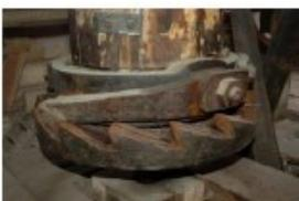
Le Steenmeulen est le seul moulin en France muni d'un dispositif de sécurité permettant d'empêcher le mécanisme de tourner à l'envers.
